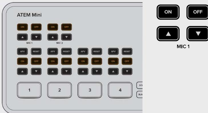
**ON** – Lorsque l'audio de l'entrée est réglé sur On, vous l'entendrez en permanence, même si la source n'est pas à l'antenne.
