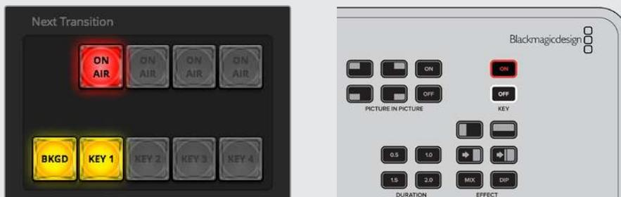
Changer le paramètre **On Air** du menu de l'écran LCD modifie également l'état du bouton **On Air** de la Transition suivante sur l'ATEM Software Control.
