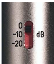
Figura 4: Interruptor para la preatenuación
