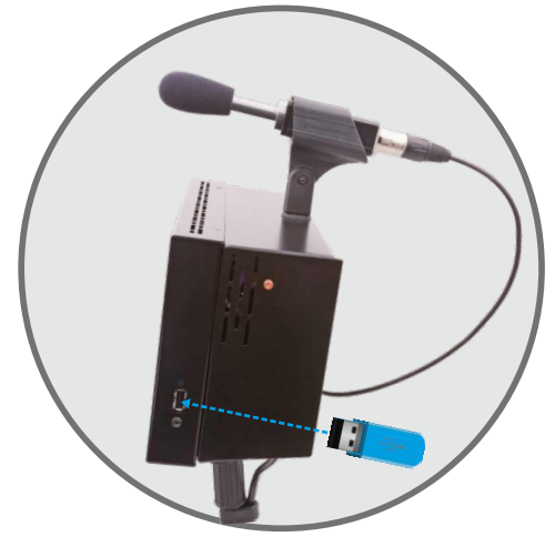
Embase USB permettant le téléchargement de l'historique et la mise à jour de l'afficheur
